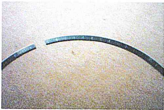
Anillos con marcas de Pre ignición
